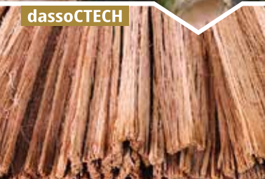
Cortado longitudinalmente, dividido en tiras y extrayendo la corteza
